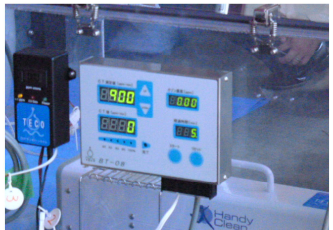
専用アクリル製 CT ボックス（オゾンガス発生装置及び CT 計測器内蔵）
