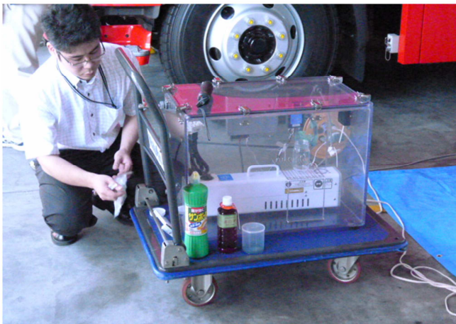
専用アクリル製 CT ボックス（オゾンガス発生装置及び CT 計測器内蔵）
