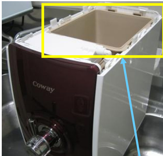
タンク(蓋を外した状態)
